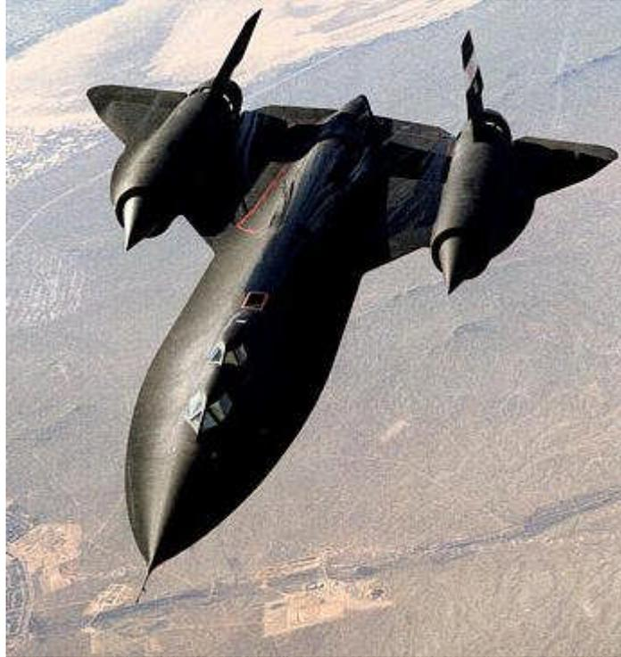
Tres aviones en los que se usa el titanio. El F117 en la zona de los motores, el Su29 en el tren de aterrizaje, y el SR71 en muchas partes del fuselaje, debido a las altas temperaturas que alcanza en vuelo...
